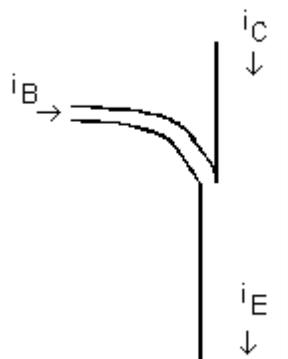
Figure 92:  $i_E = i_B + i_C$
