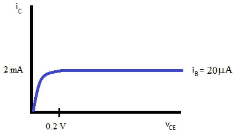
Figure 95:  $i_C$  vs.  $V_{CE}$
