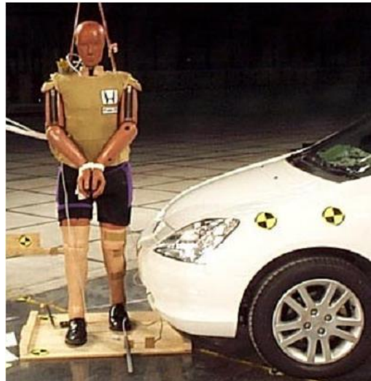
Hình 1- Sơ đồ thử nghiệm va chạm với mô hình người đi bộ đầy đủ []
