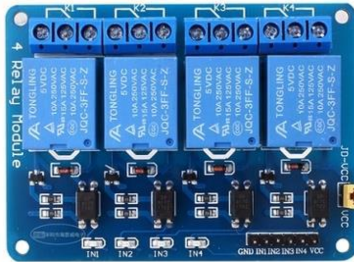
Hình 35: Mạch 4 Relay Opto.
