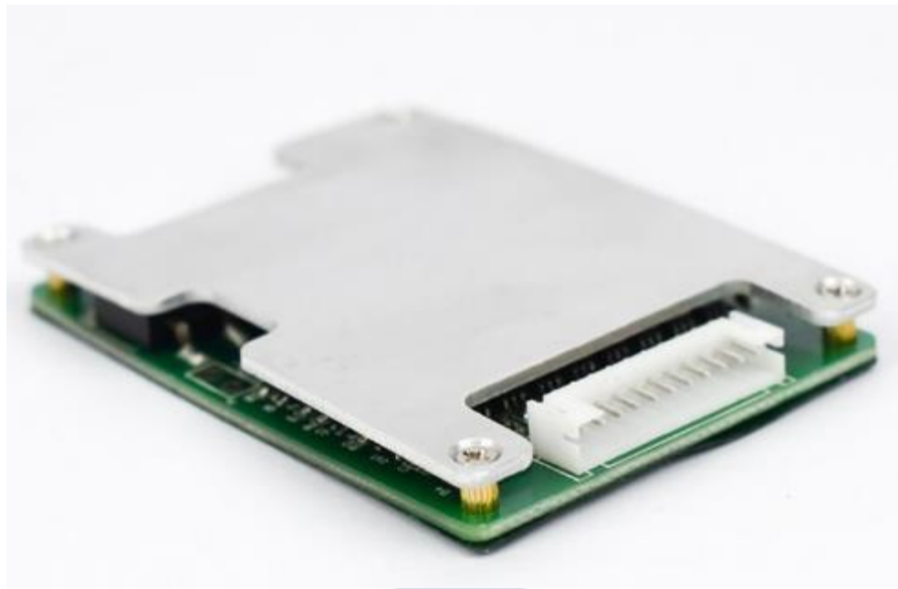
Hình 13: Mạch 10s 80a đa năng, sạc và bảo vệ cell Li-on 3.7V
