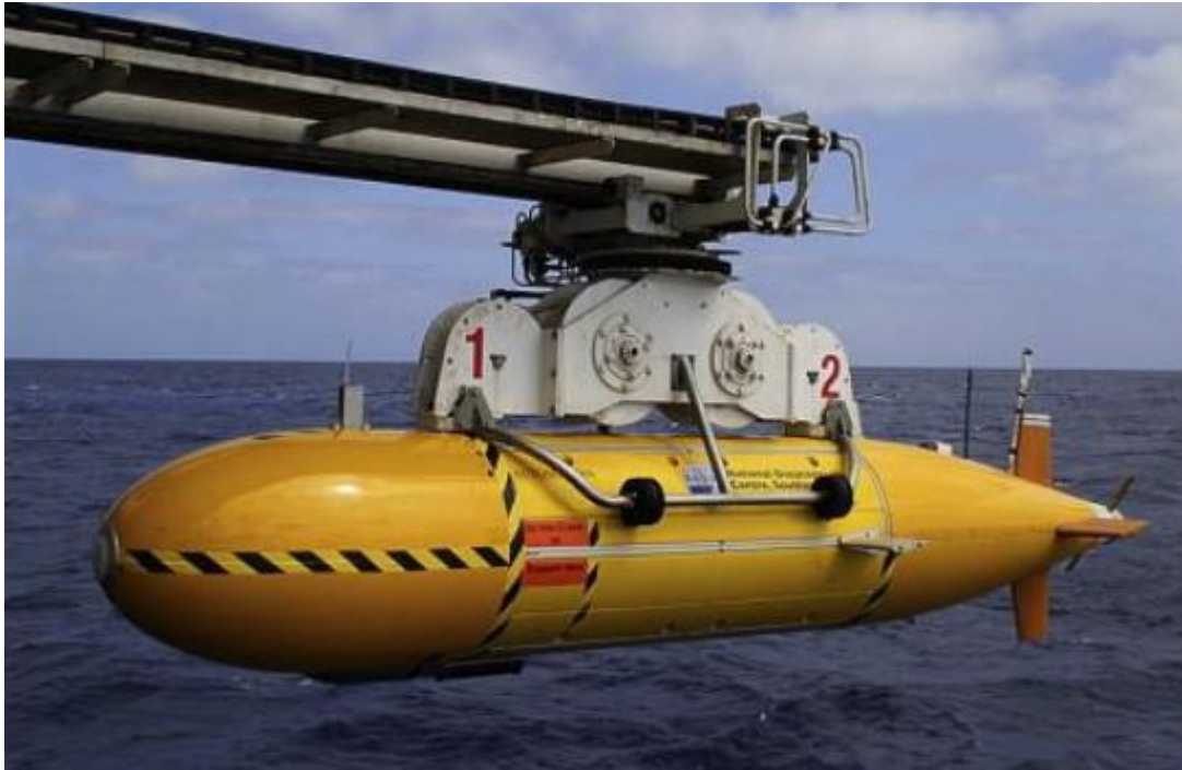
Hình 31. Thiết bị lặn tự hành phát triển bởi UK Natural Enviromental Council (NERC) model Autosub6000
