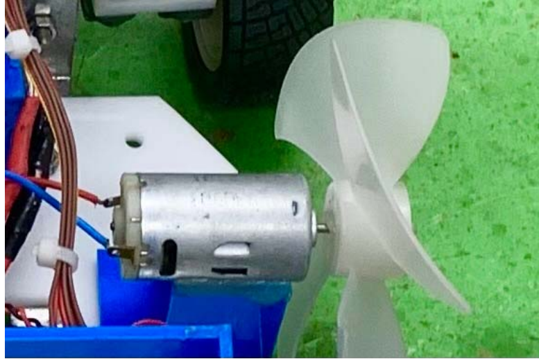
Hình 6.34: Cụm Motor phát điện bằng năng lượng gió
