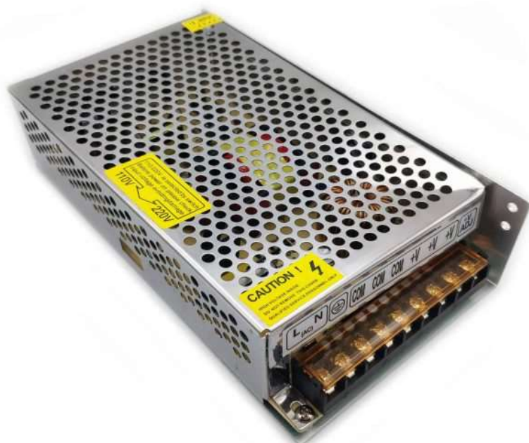
Hình 3.11: Nguồn điện 24V, 3A được sử dụng.
