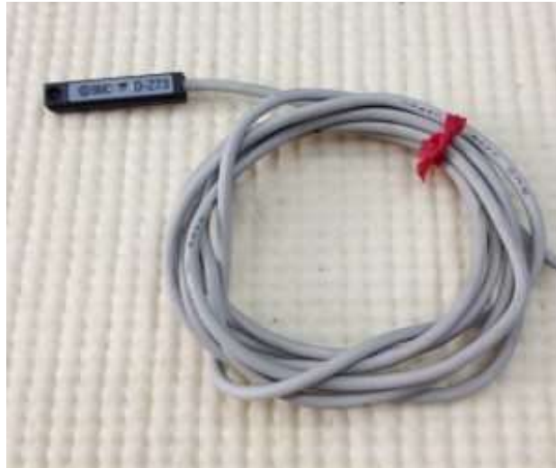
Hình 3.4. Cảm biến hành trình xi lanh D-M9N.
