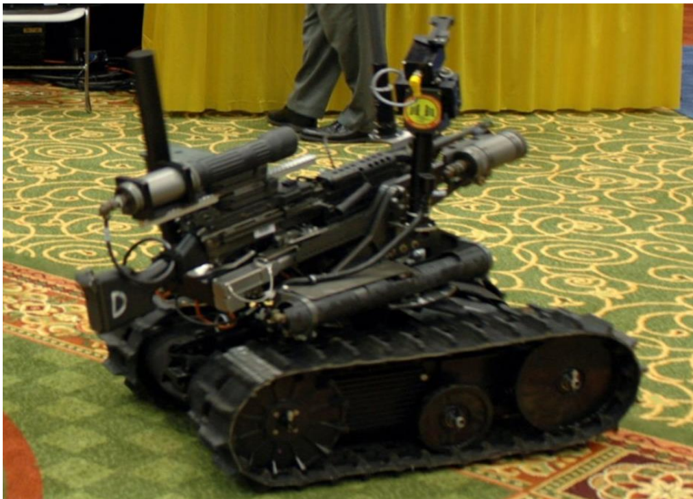
Hình 1.10: Robot TALON small dung trong quân sự.
