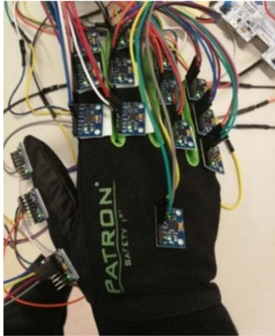
Hình 1.3: Găng tay thu nhận chuyển động của bàn tay sử dụng cảm biến gia tốc MPU5060
