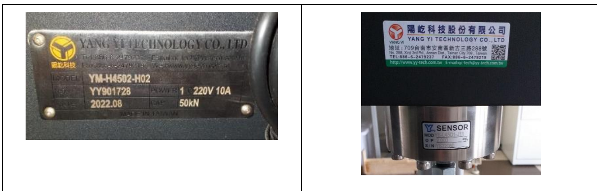
Hình 11: Bảng mã máy và hình ảnh load-cell
