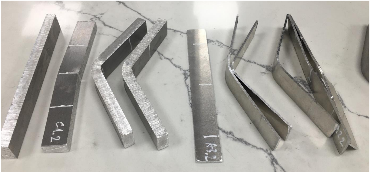
Hình 40: Hình ảnh các mẫu trước và sau khi bị uốn
