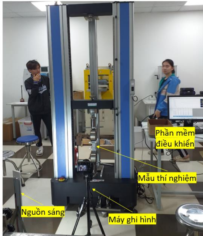
Hình 17: Các thiết bị ghi hình, quay phim, chụp ảnh, máy tính và phần mềm Microsoft Office Excel để xử lý dữ liệu
