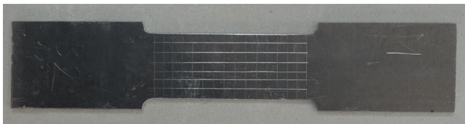
Hình 16: Mẫu thử kéo đã được khắc vạch
