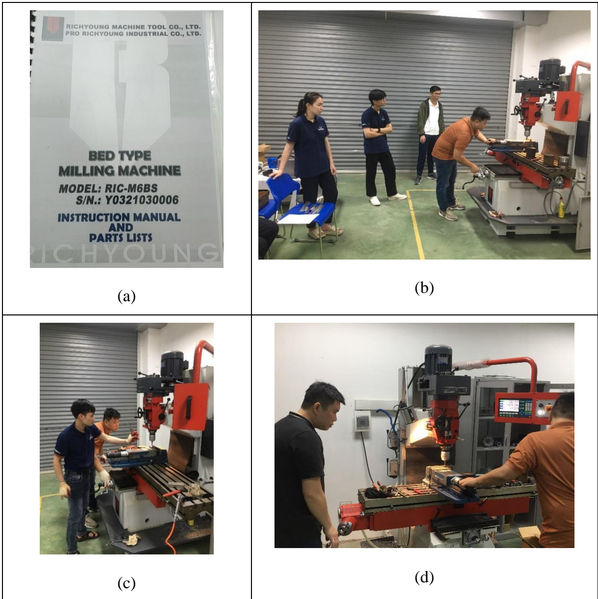
Hình 9: Máy phay vạn năng sử dụng để gia công mẫu thí nghiệm: (a) Tên thiết bị, (b-c-d) Hình ảnh trong quá trình gia công mẫu
