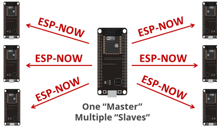
Hình 33: Nguyên lý kết nối One master – Multiple slaves
